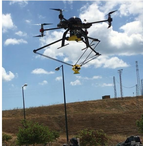
Figura 1: Manipulador aéreo con un sensor. El manipulador es un brazo de tres grados de libertad tipo delta adaptado a un octocóptero de Atyges.
