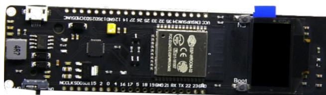
Figura 2.3: Microcontrolador ESP-32 TTGO.
