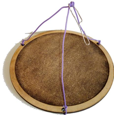
Figura 4.2: Plato donde colocar las masas durante la calibración.
