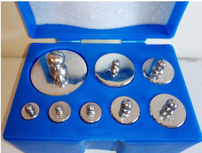
Figura 4.1: Pesas utilizadas para la calibración.
