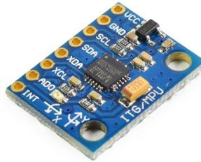
Figura 2.11: Sensor inercial de medida MP6050 (Fuente: [NAYLAMP MECHATRONICS](#))
