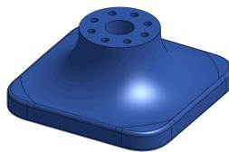
c) Placa de Montaje del Efecto (End Effector Mounting Plate)
