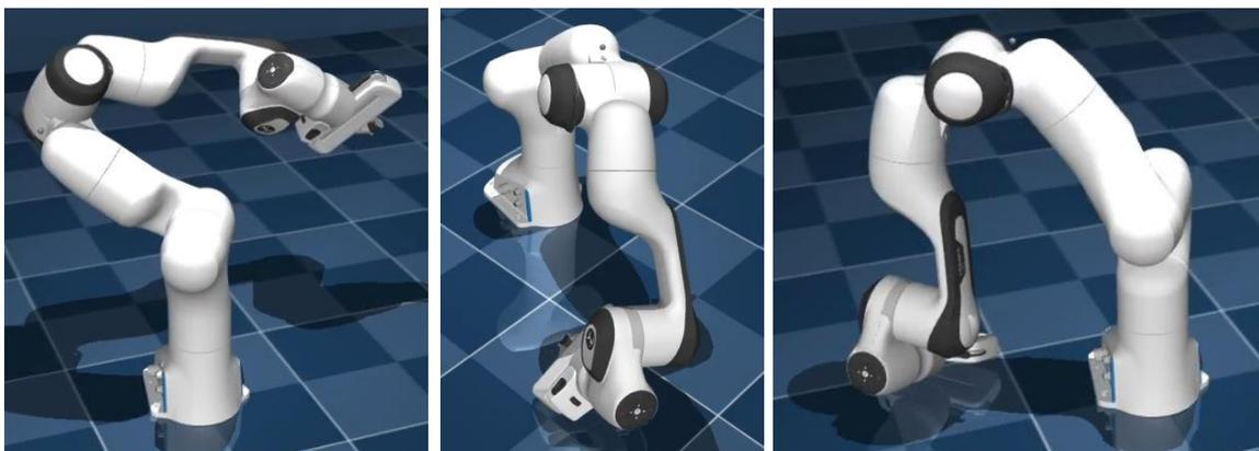
Figura 4.9: Imágenes del vídeo de reach5\_1 en modo TEST\_GUI. La captura de la izquierda muestra el efector final estable en un punto. Las capturas del centro y la derecha muestran colisiones del efector final con el suelo.
