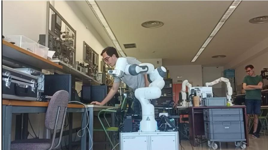
Figura 4.23: Manipulador Franka Emika Panda con el efector final en el punto objetivo, situado a la izquierda. La orientación, aunque es aproximadamente vertical, tiene un error visiblemente mayor a la posición.
