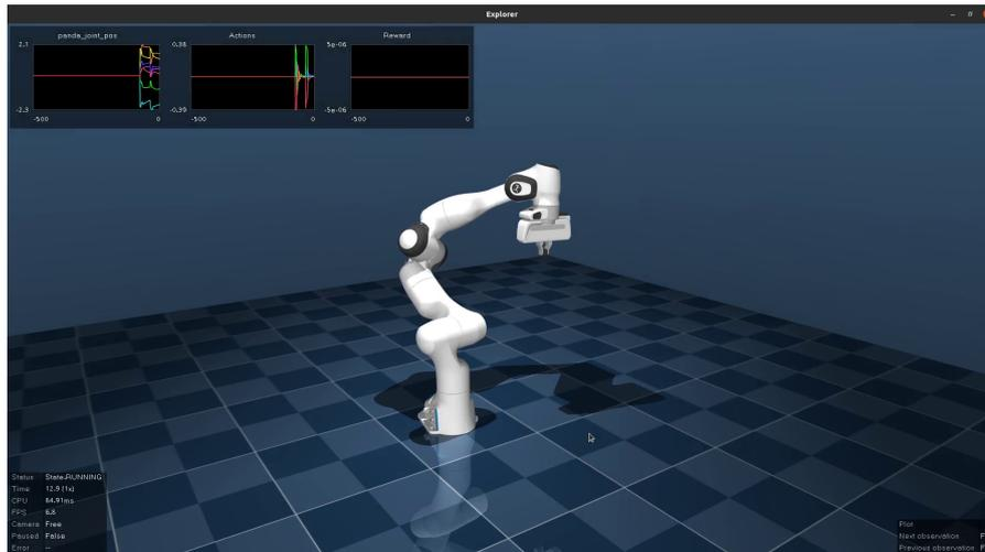
Figura 4.10: Captura del vídeo de reach5\_2 en modo TEST, donde el efector final alcanza de manera efectiva el objetivo.
