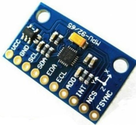
Figura 3.3: Módulo MPU 92/65. (Fuente: [4])
