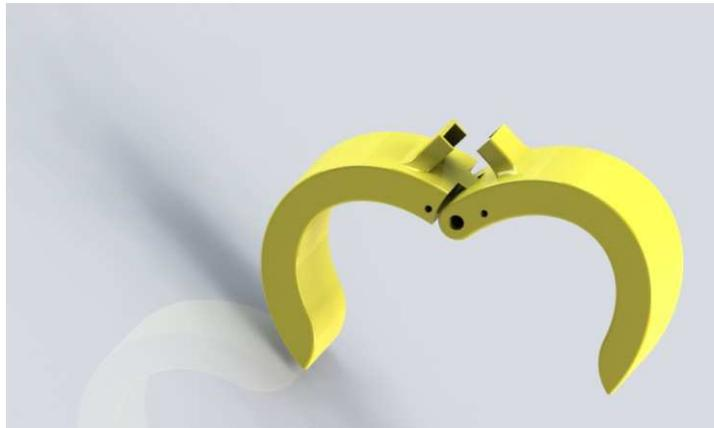
Figura 5.4: Segundo prototipo de la pinza, modelo de dos piezas inicial.
