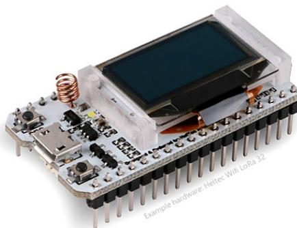
Figura 3.6: Módulo Wi-Fi LoRa 32 de *Heltec Automation*. (Fuente: [6])
