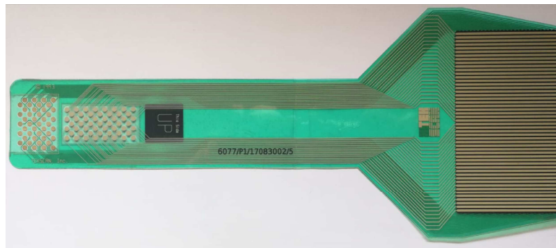
Figura 1.3: Sensor TekScan modelo 6077
