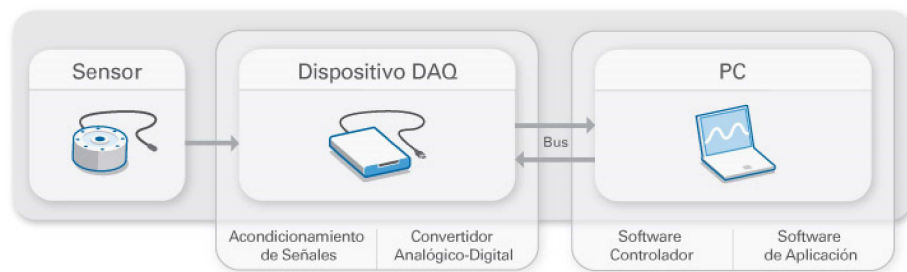
Figura 1.1: Partes de un Sistema de Adquisición de Datos
