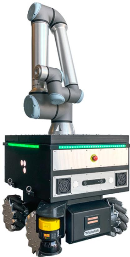
Figura 1.4: Foto del robot RB-Kairos de Robotnik. Fuente:<sup>10</sup>.
