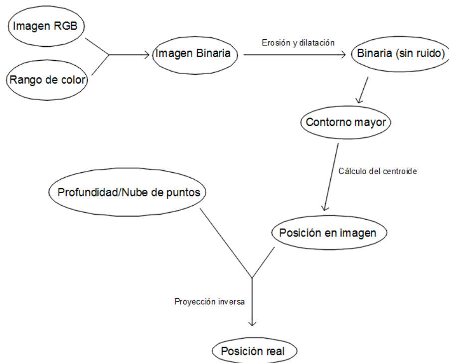
Figura 4.13: Esquema del proceso de localización. Se calcula la posición real del objeto partiendo de la imagen RGB y el rango de color, y el mapa de profundidad o la nube de puntos
