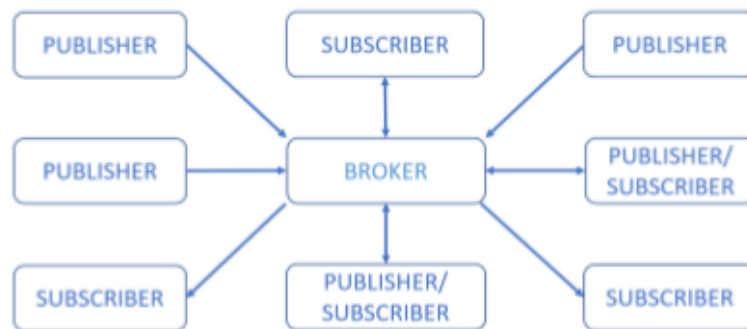
Figura 4.5: Topología en estrella del protocolo MQTT.
