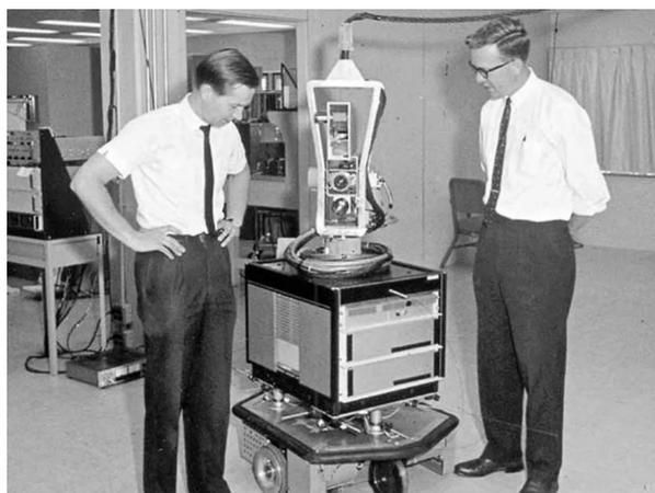
Figura 1.3: El robot Shakey desarrollado por SRI entre 1966 y 1972. Fuente: <sup>3</sup>
