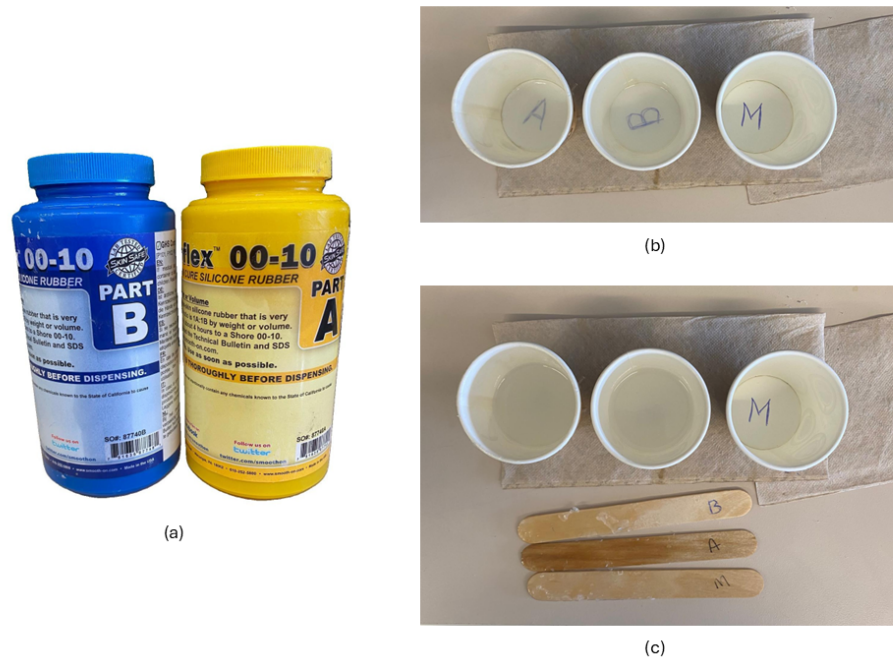
Figura 4.15: Preparación de los compuestos A y B para la mezcla de silicona. (a) Compuestos de silicona EcoFlex 00-10 A y B. (b) Vasos para compuestos A y B y para la mezcla vacíos. (c) Vasos de compuestos A y B llenos y depresores de madera.
