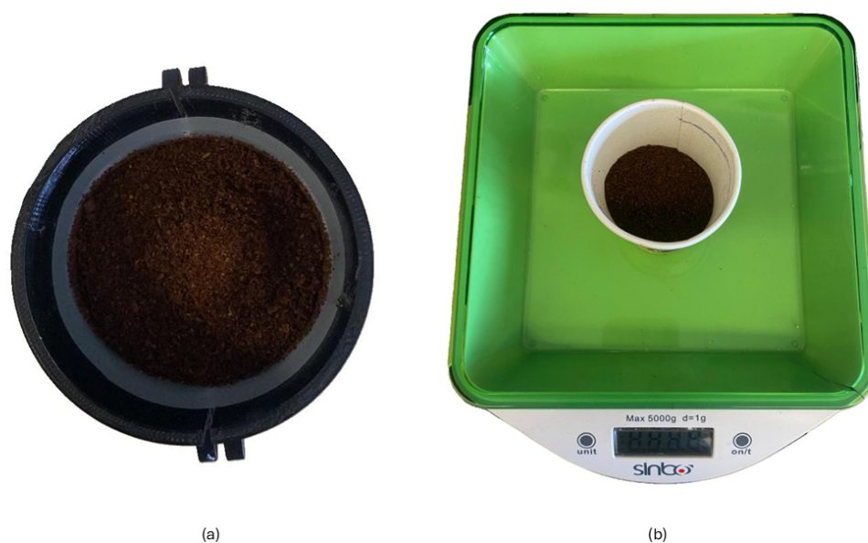
Figura 4.23: Relleno de la “manga” de silicona con café. (a) “Manga” rellena de café con los moldes atornillados para contenerlo. (b) Pesaje de café con báscula.
