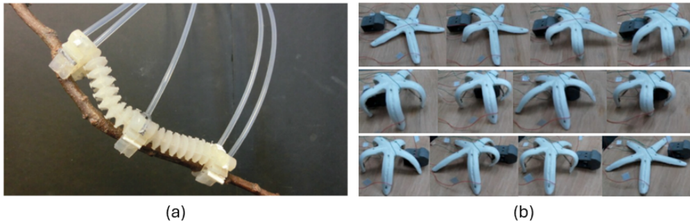
Figura 3.4: Ejemplos de robots blandos bio-inspirados. (a) Robot inspirado en una oruga. (b) Robot inspirado en una estrella de mar. (Fuente: ver texto).
