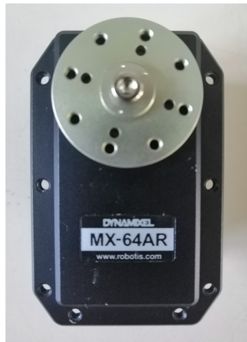
Figura 3.2: Fotografía del servomotor Dynamixel MX-64AR. Se muestra el eje motorizado.
