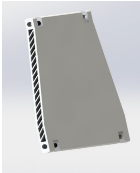
Figura 2.22: Modelo de pieza flexible tipo sándwich para su impresión en material FLEX.
