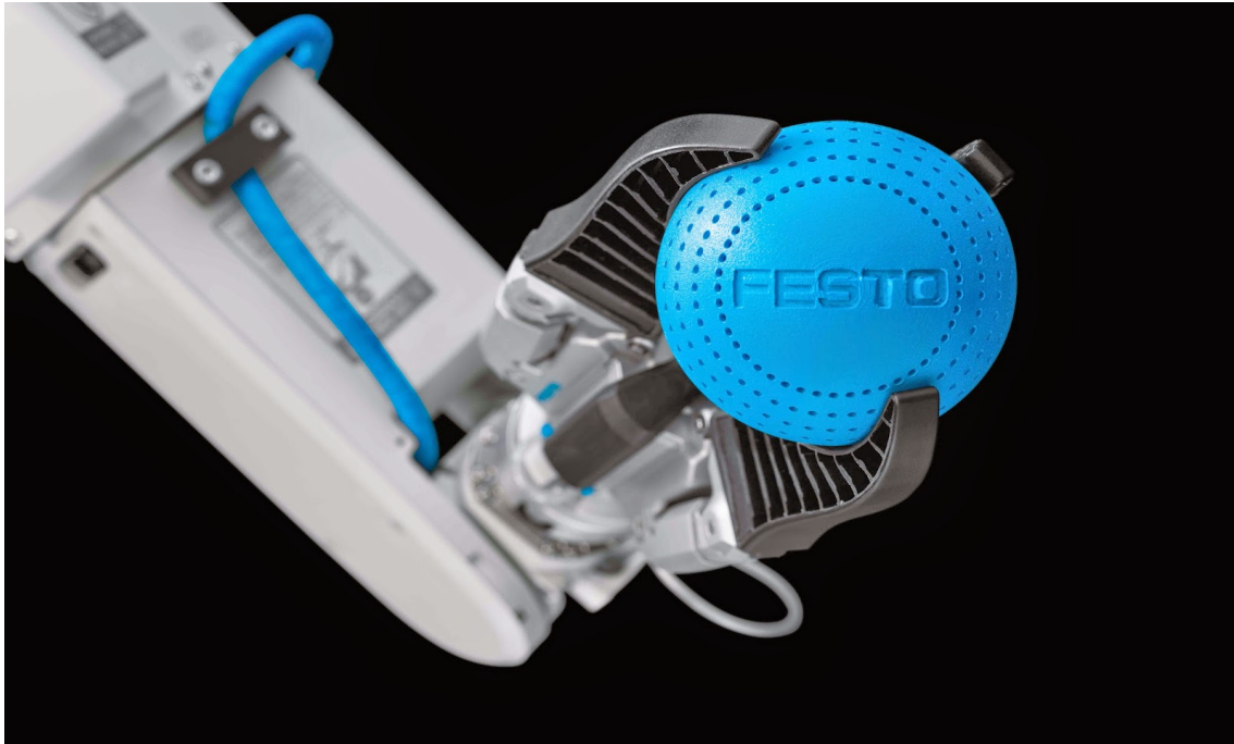
Figura 1.2: Pinza MultiChoiceGripper creada por Festo agarrando un objeto. [Fuente: [3]]
