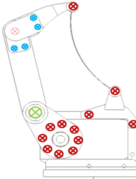
Figura 2.21: Esquema de colocación de tornillos según la simbología especificada en la Tabla ???. No será necesario el uso de tuercas para la unión de la pinza con el eje móvil del servomotor, en la parte inferior de los eslabones H_4 ni para la unión de los cubre-potenciómetros, sí se utilizarán en el resto de casos.
