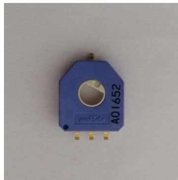
Figura 3.3: Fotografía del potenciómetro muRata modelo SV01 10k \Omega lineal.
