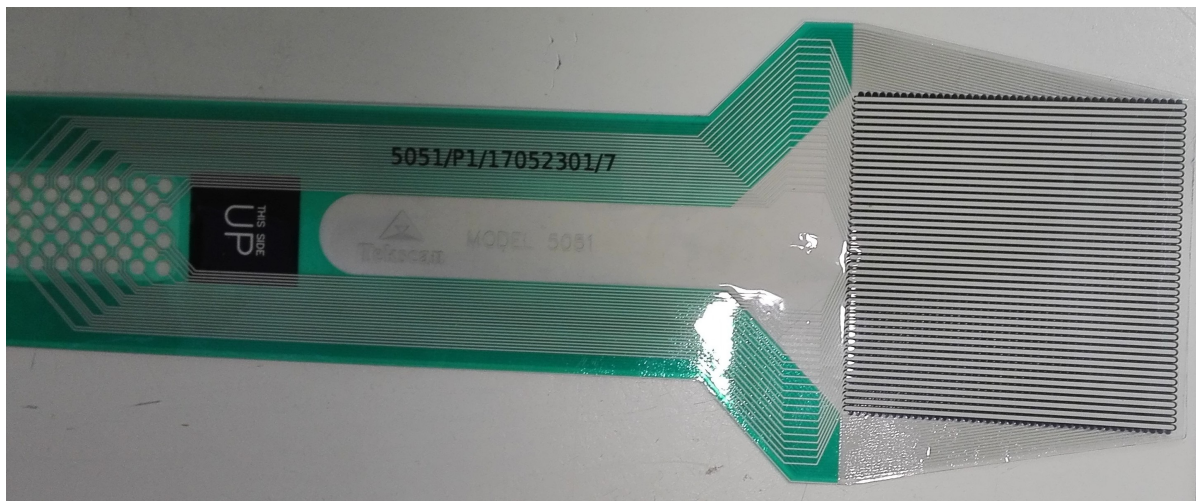
Figura 3.1: Fotografía del sensor táctil modelo 5051 de Tekscan . A la derecha se encuentra la matriz de sensel y, a la izquierda, la zona de conexión con el dispositivo de adquisición de datos.
